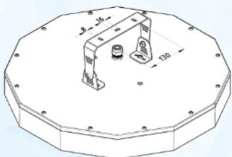
Отверстия М6х1 глубиной 10мм
